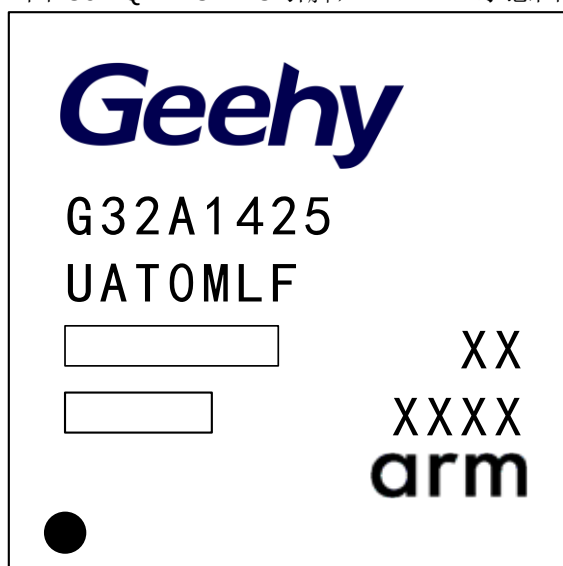
图 30 LQFP48 – 48 引脚，7 x 7mm 示意图
