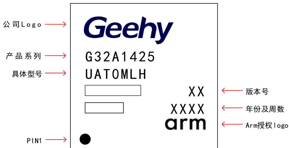
图 29 LQFP64 – 64 引脚，10 x 10mm 示意图
