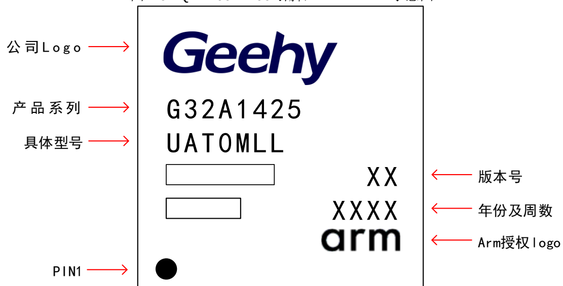
图 26 LQFP100 – 100 引脚，14 x 14mm 示意图
